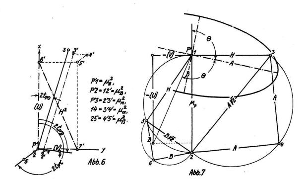
Halbkreis und bestimmen die große Halbachse A der Fehlerellipse als Kathete des gleichschenklig rechtwinkligen Dreiecks.
