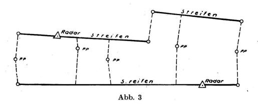
Als Projektion wurde eine Lambert'sche Kegelprojektion gewählt, mit dem Meridian, der das Aufnahmegebiet halbiert, als Zentralmeridian. Die Radarfixpunkte und die berechneten Werte der Polygonpunkte wurden aufgetragen. Diese Grundlagen dienten für die Orientierung nach der Methode der «metal templets», wie sie für Trimetrogon-Aufnahmen üblich ist. Es handelt sich um die bekannte Methode der graphischen Aerotriangulation mit Metallmatrizen, der dann die Auswertung am Multiplex folgt.
