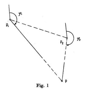
Im Beispiel werden hier dieselben Punkte  $P_1$  und  $P_2$  benützt wie bei der Azimutrechnung; die Azimute und ihre Tangenten sind:
