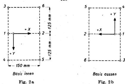
zeichnet man die Mittelpunkte der Bereiche in der Ebene Z=400 mm, entsprechend den Figuren 2 a und b, mit den Ziffern  $1 \dots 6$ , so erhält man, basierend auf der Formel (2) und entsprechend den Formeln (6) in [5] für die Unbekannten  $dby_0 \dots d\Delta \kappa_0$  die folgenden Ausdrücke:
