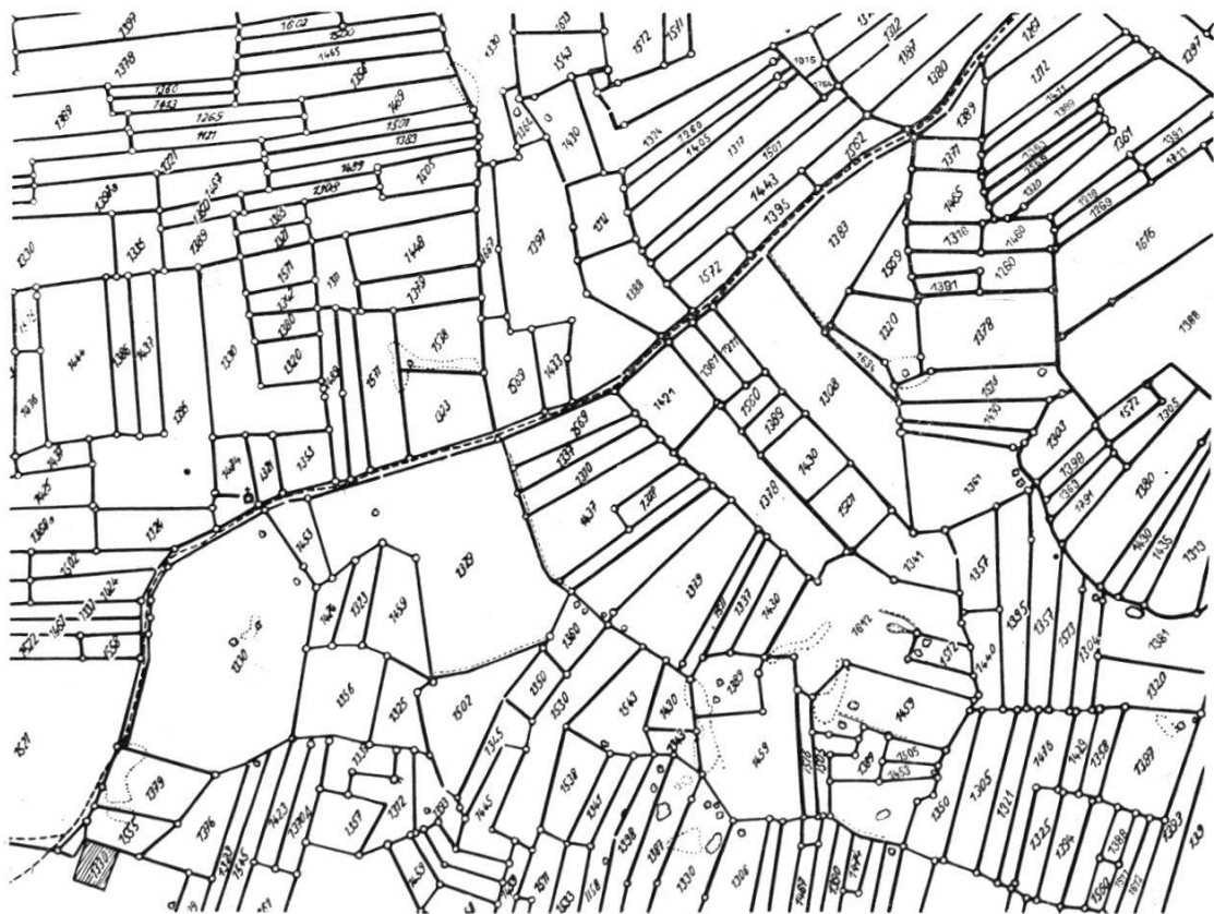
Fig. 6. Reproduktion eines Ausschnittes des luftphotogrammetrisch erstellten Situationsplanes 1:1000 „Media Blenio“
