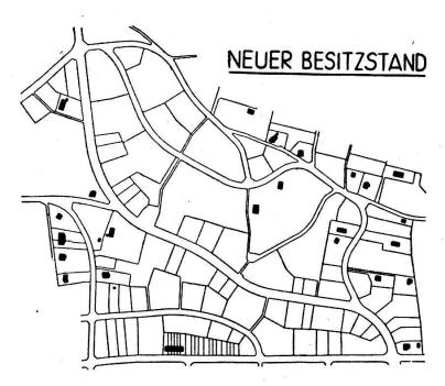
Grundstückeinteilung nach durchgeführter Baulandumlegung.
