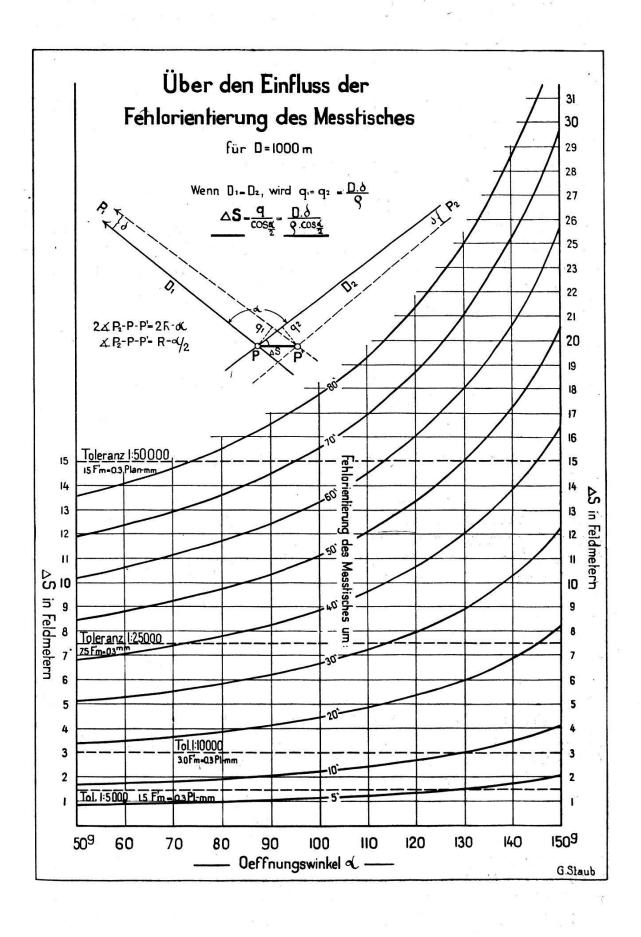
Es geht daraus hervor: Schnitte mit stumpfen Winkeln (R + a) sind bei unkontrollierter Bussolenorientierung ungleich gefährlicher als mit spitzen Winkeln (R - a).
