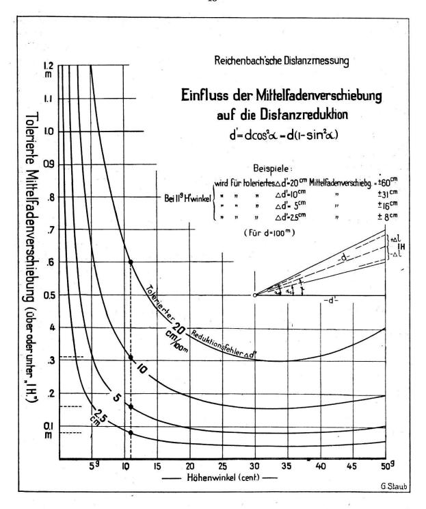
stallisiert sich die praktische Frage heraus: «Um welchen Lattenbetrag  $\Delta l$  darf der Mittelfaden nach oder vor erfolgter Höhenwinkelmessung (auf IH) nach oben oder unten verschoben werden, um keinen größeren Reduktionsfehler als 2,5 ...5...10....25 cm. pro 100 m zu verursachen?»
