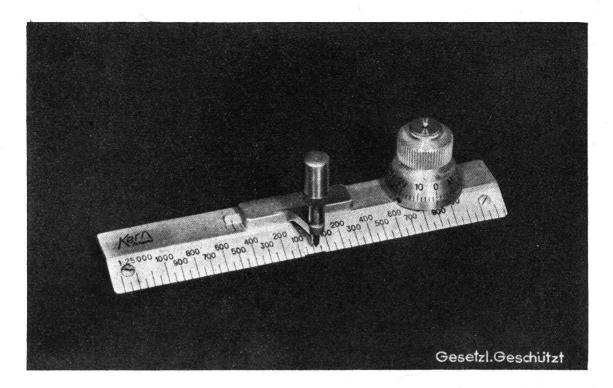
halten ist, so kann praktisch der Übertragungsmechanismus als fehlerfrei angesehen werden. Es verbleibt also in der Hauptsache nur der oben erwähnte Fehler der Indexeinstellung von 0,025 bis 0,03 mm für die Gesamtfunktion eines Distanzauftrages, d. h. ca.  $^1/_3$  der bis anhin getätigten Meßtisch-Auftragsmethoden.
