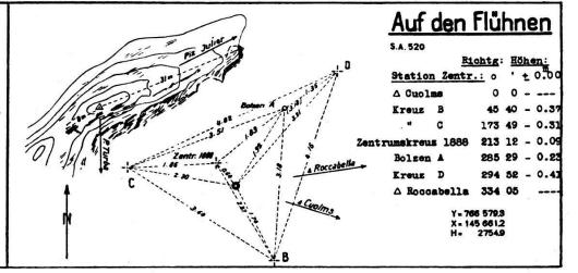
Abb. 13. Protokoll der Punktversicherung für Stationen I.-III. Ordnung
