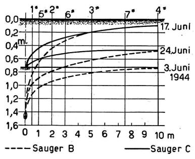
Abb. 38. Abgesenkte G.W.Sp.
