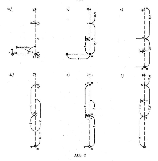
(Abb. 2 d). Der Theodolit wird zentriert, Punkt 28 wird anvisiert, das Fernrohr durchgeschlagen und A wird eingewiesen (Abb. 2 e). Dann geht A weiter, der inzwischen bei Punkt 28 angekommene H wird abgerufen. Der erste Zwischenpunkt wird durch einen Fluchtstab signalisiert, und dann wiederholt sich der Messungsvorgang bis zur Erreichung des Punktes 11.
