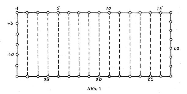
Als Grundnetz der Aufnahme wurde ein Polygon gewählt (Abb. 1), dessen Seitenlängen zweimal mit 20-m-Meßband und dessen Brechungswinkel durch Zweisatz-Winkelmessung bestimmt wurden. Die Höhen der Polygonpunkte wurden durch ein Doppelnivellement (Zielweiten bis 80 m) bestimmt. Zwei gegenüberliegende Punkte der zum Fluß parallelen Seiten wurden durch ein Profil verbunden, dessen Vermessung im folgenden näher beschrieben wird.
