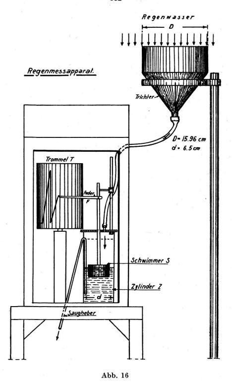
Trichter hat einen Durchmesser  $D \subseteq 16$  cm und eine Oberfläche von  $200 \text{ cm}^2$ . Die Lage des Wasserspiegels im Zylinder wird mittels des Schwimmers S und der Feder F auf die Trommel T übertragen. Letztere besitzt ein Uhrwerk mit einer Laufzeit von etwa sieben Tagen. Sobald der Zylinder Z voll ist, entleert er sich mittels des Saughebers automatisch. Der Schwimmer bzw. die Feder sinkt dann plötzlich und steigt von unten nach oben wieder an.
