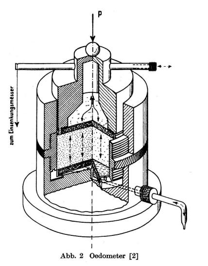
Apparat zur kombinierten Messung der Zusammendrückbarkeit, Durchlässigkeit und Kapilarität.
