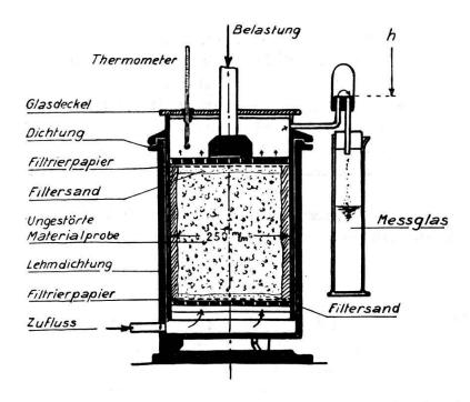
Abb. 3b [3] Schematischer Schnitt durch den Preßtopf
