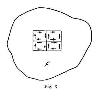
intérieurs au pourtour de F sont décrits dans les deux sens. Il en résulte que l'on peut négliger ces côtés et qu'il suffit de suivre avec la pointe traçante le pourtour complet de F pour trouver sa superficie.
