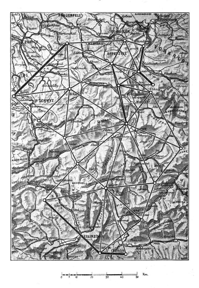
Abb. 6. Hauptnetz des ersten Alpenüberganges 1826-1832 von Buchwalder, zum Zusammenschluß der Dreieckseiten aus den französischen, österreichischen und lombardischen Netzen
