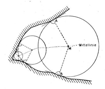
Abb. 3. Einbeschriebene Kreise und Mittellinie
