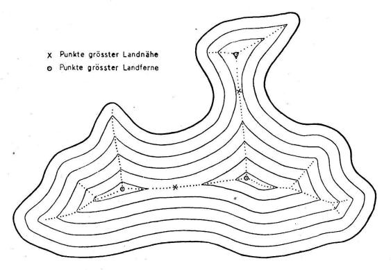
Abb. 7. See mit Uferparallelen (Hüllkurven), Mittellinie und ausgezeichneten Punkten
