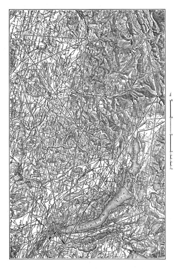
Abb. 4. Hauptdreiecksnetz Nordostschweiz 1794-1814. Basisnetz von Feer 1794/97, Netz von Pestalozzi 1809/14
