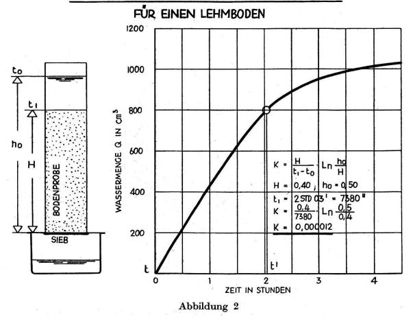
Höhe  $h_0$  mit Wasser angefüllt. Die untenauslaufende Wassermenge wird, gemessen und als Funktion der Zeit graphisch aufgetragen (Abbildung 2). Die Zeit  $t_1$ , das ist die Zeit, bei der die Wassersäule den Wert H erreicht, muß ebenfalls abgelesen werden. Mit Hilfe der ausgelaufenen Wassermenge bis zur Zeit  $t_1$  und den verschiedenen Wasserhöhenablesungen kann die Durchlässigkeitsgröße, Filtrationskonstante genannt, berechnet werden. Die Berechnung geschieht nach folgender Formel:
