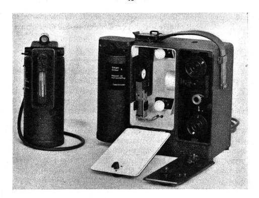
Fig. 1. Registrier-Statoskop
