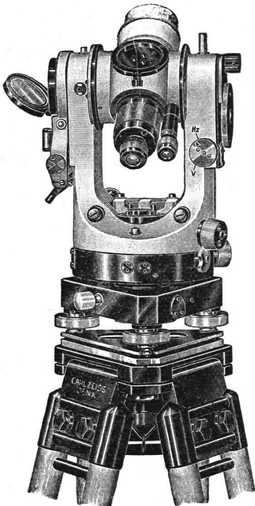
Direkte Ablesung 1", Schätzung  $\frac{1}{10}$ . Fernrohrvergrößerung 27fach. Objektivöffnung 40 mm. Gewicht (Instrument und Behälter) etwa 11 kg.
