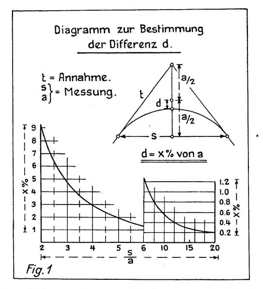
in diesen Fällen ist das Diagramm nützlich zur raschen Feststellung, ob diese Näherung erlaubt ist oder ob die Größe d noch berücksichtigt werden muß.
