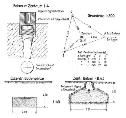
Fig. 27. Zentrische und exzentrische Versicherung der Basispunkte Ostermundigen (1913).
