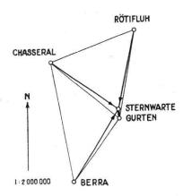
Fig. 25. Anschlußnetz der Sternwarte Bern an das Gradmessungsnetz (1876).
