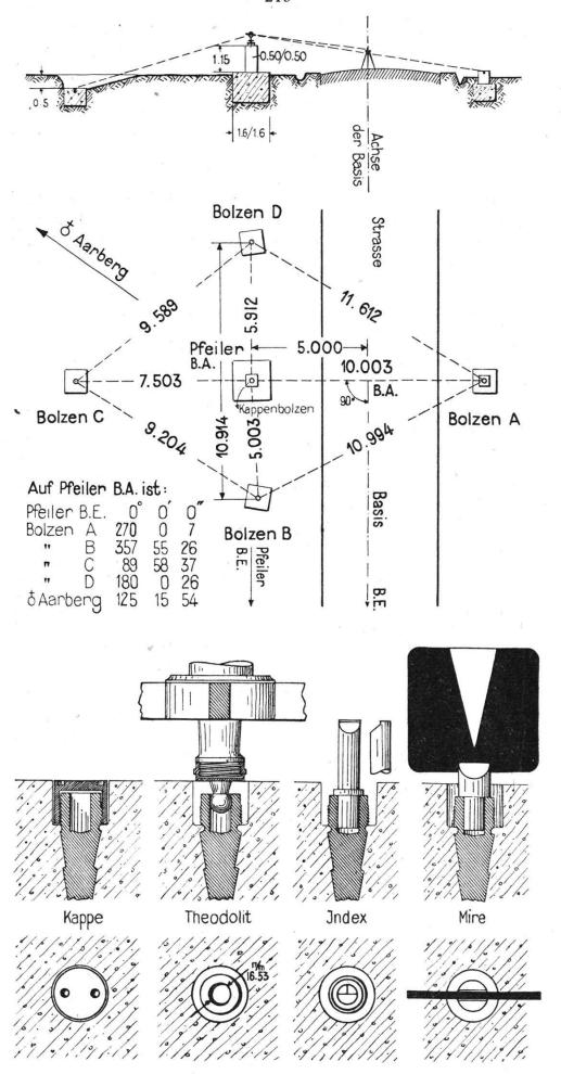
Fig. 29. Vorschlag einer Normalversicherung eines Basispunktes.
