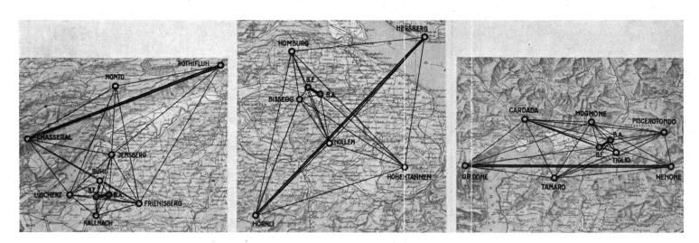
Fig. 20. Übertragung der Basislängen auf die Seiten der Gradmessungstriangulation (Basisanschlußnetze) 1880/84.
