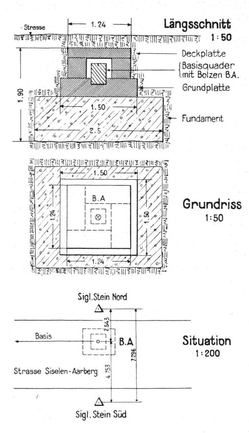
Fig. 15. Versicherungsart der Basispunkte für Aarberg, Weinfelden und Giubiasco 1880/81. (Beispiel Aarberg B. A.).
