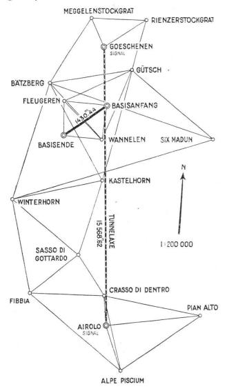
Fig. 13. Netzplan von Ing. Gelpke für die Richtungsbestimmung des Gotthardtunnels (1870).
