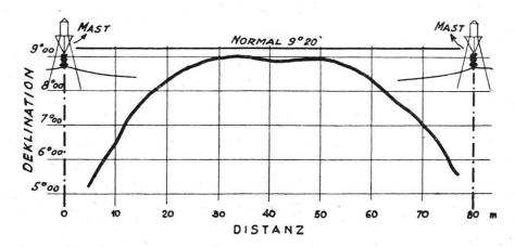
Fig. 3. Diagramm der Deklinationsveränderung in Richtung der Starkstromleitung.
