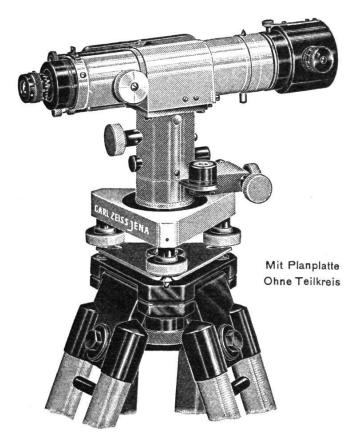
mit und ohne Teilkreis. Stabiles, handliches Instrument für alle technischen Einwägungen jeglicher Genauigkeit. Mit Planplatte für Feineinwägungen geeignet. Umlegbares Fernrohr mit 31 facher Vergrößerung, Innenfokussierung. Parallaxenreie Beobachtung der Libelle durch Lupe und Prismen-System neben Okular. Gewicht des Instrumentes ohne Teilkreis 2,7 kg. Mittlerer Fehler pro 1 km Doppelnivellement 2 mm (mit Planplatte 0,7 mm) Einspielgenauigkeit der Libelle 0,5 %.
