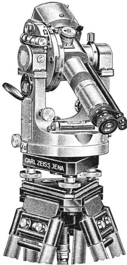
Optischer Präzisionsdistanzmesser für Polygonierung und Stückvermessung
