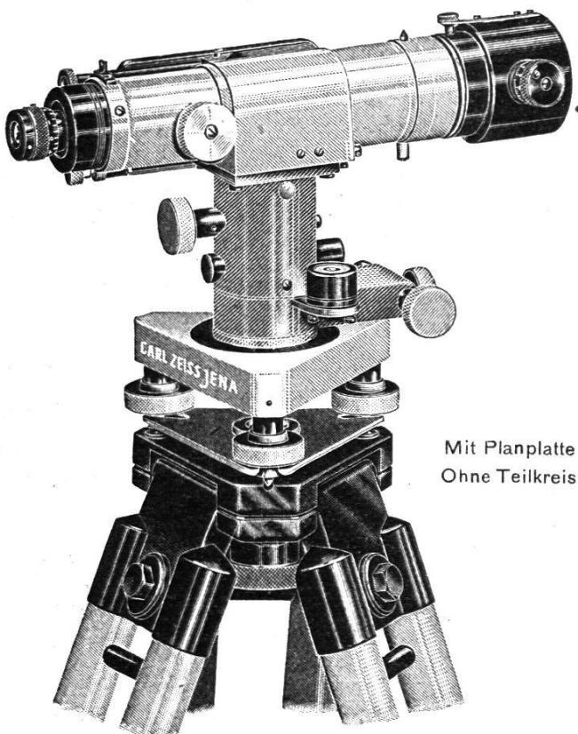
mit und ohne Teilkreis. Stabiles, handliches Instrument für alle technischen Einwägungen jeglicher Genauigkeit. Mit Planplatte für Feineinwägungen geeignet. Umlegbares Fernrohr mit 31facher Vergrößerung, Innenfokussierung. Parallaxenreie Beobachtung der Libelle durch Lupe und Prismen-System neben Okular. Gewicht des Instrumentes ohne Teilkreis 2,7 kg. Mittlerer Fehler pro 1 km Doppelnivelllement 2 mm (mit Planplatte 0,7 mm) Einspielgenauigkeit der Libelle 0,5".
