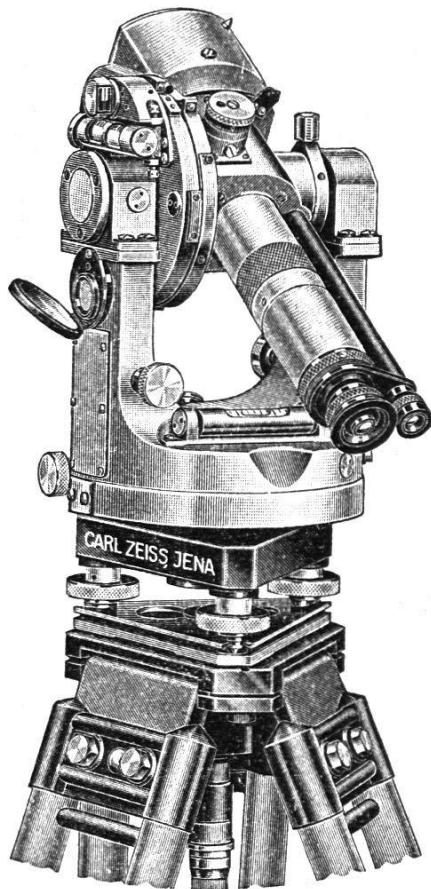
Optischer Präzisionsdistanzmesser für Polygonierung und Stückvermessung
