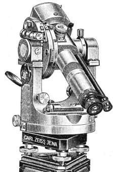
Optischer Präzisionsdistanzmesser für Polygonierung und Stückvermessung
