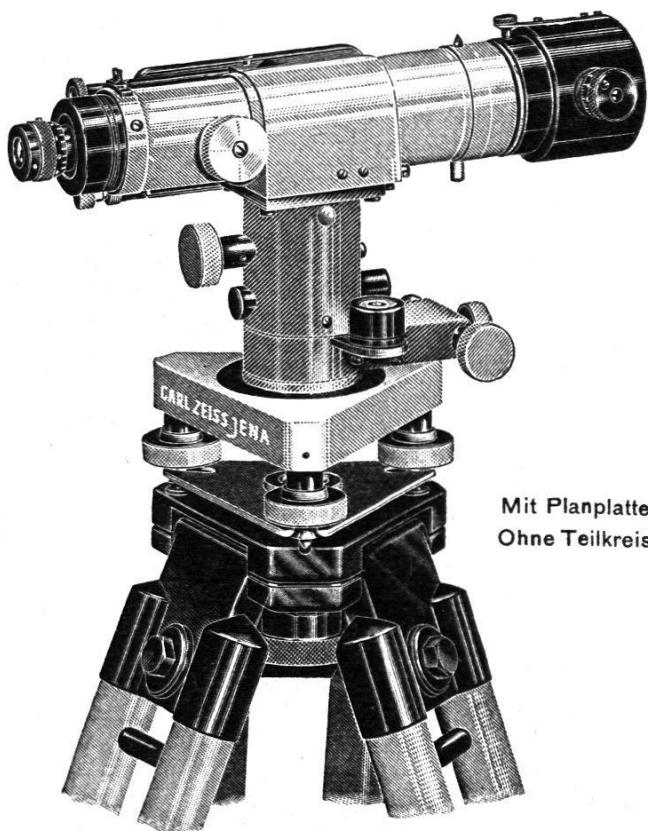
mit und ohne Teilkreis. Stabiles, handliches Instrument für alle technischen Einwägungen jeglicher Genauigkeit. Mit Planplatte für Feineinwägungen geeignet. Umlegbares Fernrohr mit 31 facher Vergrößerung, Innenfokussierung. Parallaxenfreie Beobachtung der Libelle durch Lupe und Prismen-System neben Okular. Gewicht des Instrumentes ohne Teilkreis 2,7 kg. Mittlerer Fehler pro 1 km Doppelnivellelement 2 mm (mit Planplatte 0,7 mm) Einspielgenauigkeit der Libelle 0,5".
