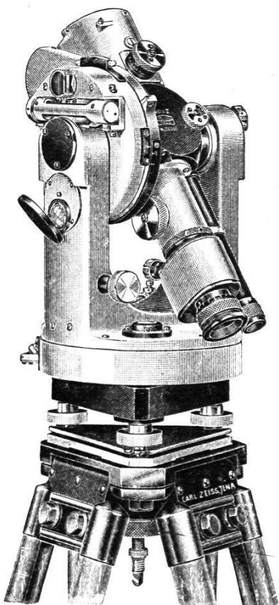
Optischer Präzisionsdistanzmesser für Polygonierung und Stückvermessung
