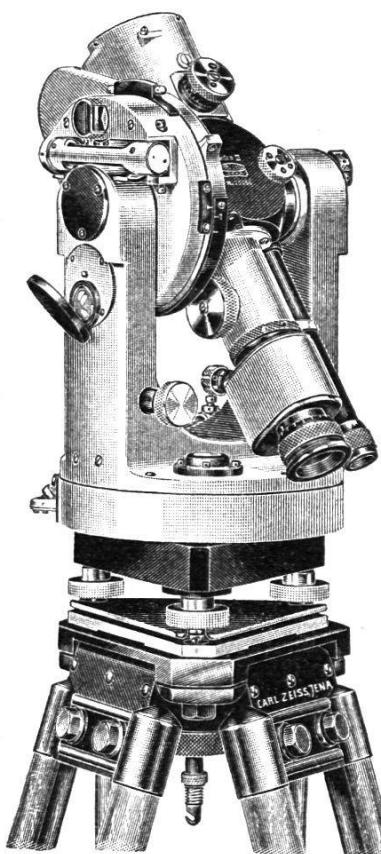
Optischer Präzisionsdistanzmesser für Polygonierung und Stückvermessung
