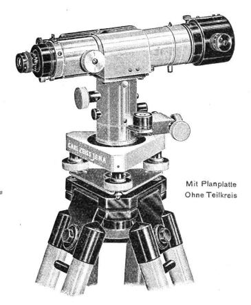
mit und ohne Teilkreis. Stabiles, handliches Instrument für alle technischen Einwägungen jeglicher Genauigkeit. Mit Planplatte für Feineinwägungen geeignet. Umlegbares Fernrohr mit 31 facher Vergrößerung, Innenfokussierung. Parallaxenfreie Beobachtung der Libelle durch Lupe und Prismen-System neben Okular. Gewicht des Instrumentes ohne Teilkreis 2,7 kg. Mittlerer Fehler pro 1 km Doppelnivellement 2 mm (mit Planplatte 0,7 mm) Einspielgenauigkeit der Libelle 0,5".
