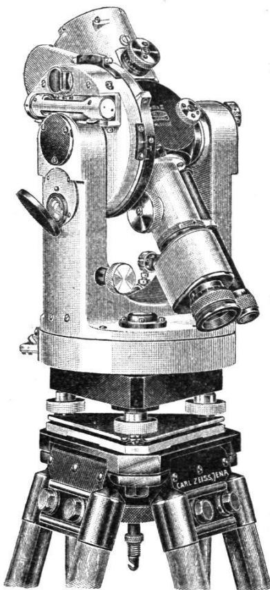
Optischer Präzisionsdistanzmesser für Polygonierung und Stückvermessung
