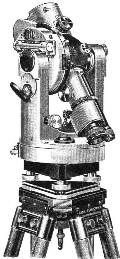
Optischer Präzisionsdistanzmesser für Polygonierung und Stückvermessung
