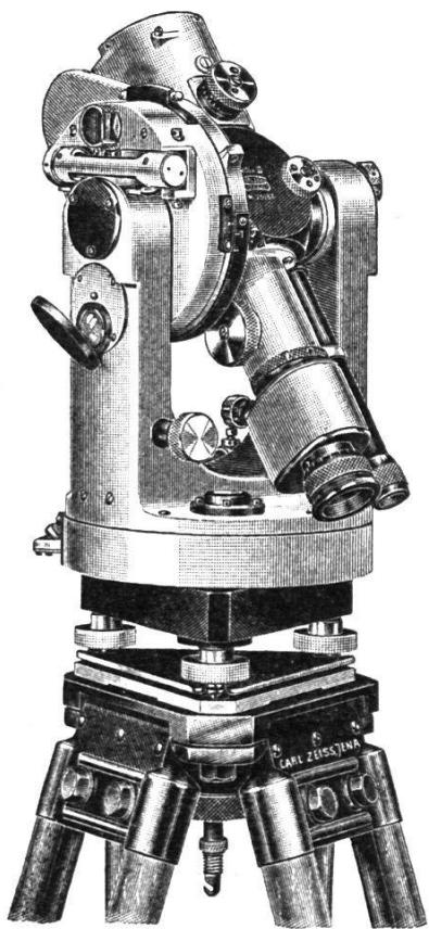
Optischer Präzisionsdistanzmesser für Polygonierung und Stückvermessung
