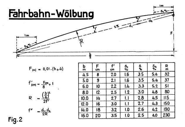
Bei Straßen mit weniger als 0.3% Längsgefälle wird der Schalenanschlag zu 10 cm beim Schalenscheitel und zu 17 cm beim Sammler angenommen, so daß gegenüber dem Normalanschlag von 12 cm die Verminderung des Anschlags im Scheitel 2 cm beträgt. Das mittlere Quergefälle der Fahrbahn vermindert sich dadurch auf 2.6% bei 4.4 m Fahrbahn und nimmt ab bis zu 2.2% bei 16 m Fahrbahnbreite. Dieses Minimal-Quergefälle ist noch genügend groß um die Entwässerung der Fahrbahn zu gewährleisten.
