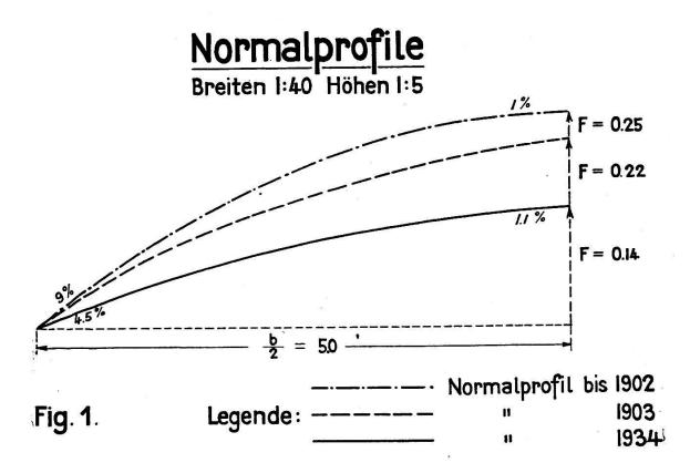
genaue Ausführung konkave Straßenhälften entstehen. Der Unterschied gegenüber dem früheren Profil ist aus der Fig. 1 zu ersehen.
