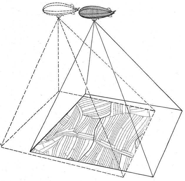
Bei einer Flughöhe von 600 m und enger Parzellierung lassen sich mit einem Stereogramm 1000 und mehr Grenzpunkte erfassen; die relative Genauigkeit der Grenzpunktbestimmung ist auf etwa  $\pm$  1 cm zu schätzen.
