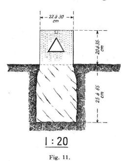
C'est précisément dans les années 1834 et 1835 que le géomètre Delarageaz repéra et observa la triangulation des districts d'Aigle et de Bex et que Mr. de Saussure fit le nécessaire pour le repèrement des points de montagne d'après ses instructions. Le repèrement, fait d'après le croquis fig. 11 avec des bornes en calcaire ou en grès, mérite d'être mentionné dans cette étude, car sa grande valeur a été prouvée indubitablement. Le
