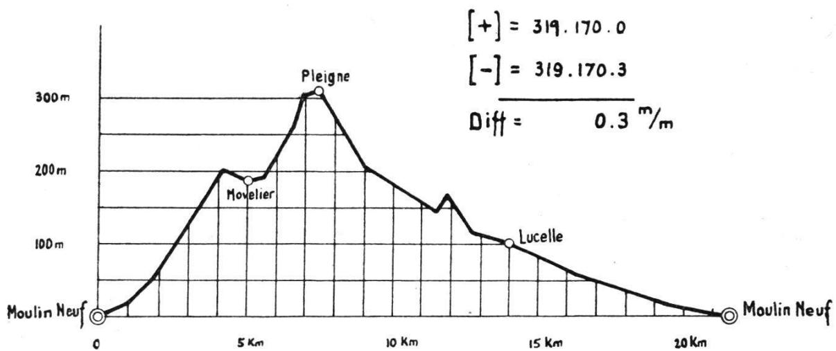
Les quelques résultats indiqués ci-dessus correspondent à la moyenne des résultats obtenus par l'Office cantonal du cadastre sur plus de 250 km de nivellation. Comme il s'agit de double nivellation c'est donc plus de 500 km qui furent effectivement nivélés.
