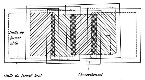
Fig. 1. Recouvrement des vues constituant une série.
