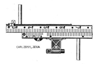
Fig. 6. Lecture: 36,40 + cm + mm au tambour de mesure du Redta.
