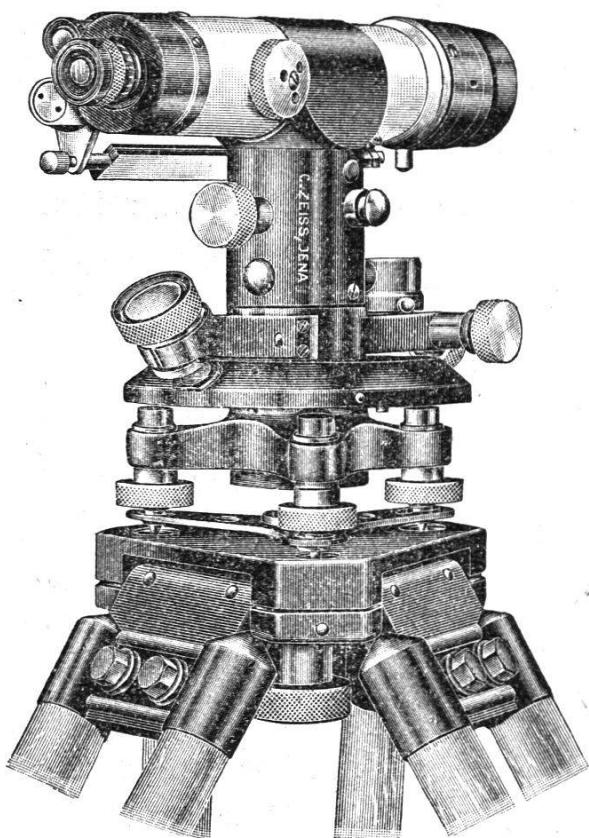
mit und ohne Teilkreis. Stabiles Instrument für alle technischen Einwägungen. Umlegbares Fernrohr mit 31facher Vergrößerung. Justiermöglichkeit von einem Standpunkt aus. Parallaxenfreie Beobachtung der Libelle durch Prismensystem und Lupe. Verdeckter Teilkreis. Ablesegenauigkeit bei  $360^\circ$  eine Minute
