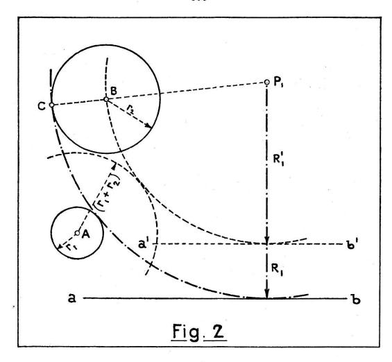
dieser Aufgabe ist dem Schreibenden nicht bekannt, dagegen führt der folgende, indirekte Weg zum Ziel. Durch die Hilfskonstruktion der Fig. 2 mit dem Kreis  $(r_1 + r_2)$  und der Tangente a'-b' läßt sich das Problem reduzieren auf die Aufgabe der Fig. 3, welche lautet: den Kreis  $R_1$  zu bestimmen, der die Gerade a'-b' und den Kreis  $(r_1 + r_2)$  berührt und durch den Punkt B geht.
