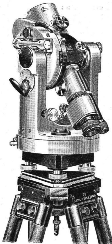
Optischer Präzisionsdistanzmesser für Polygonierung und Stückvermessung
