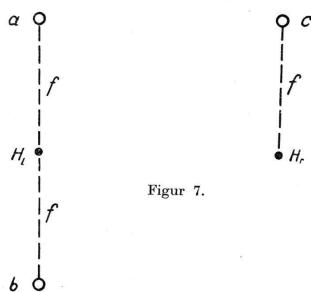
Diese drei Punkte werden am Uebertragungsgerät in beide Platten übertragen und ihre Koordinaten erhoben; der Nullpunkt der verwendeten Koordinatensysteme ist der resp. Hauptpunkt, die x-Achse die Richtung zum andern übertragenen Hauptpunkt
