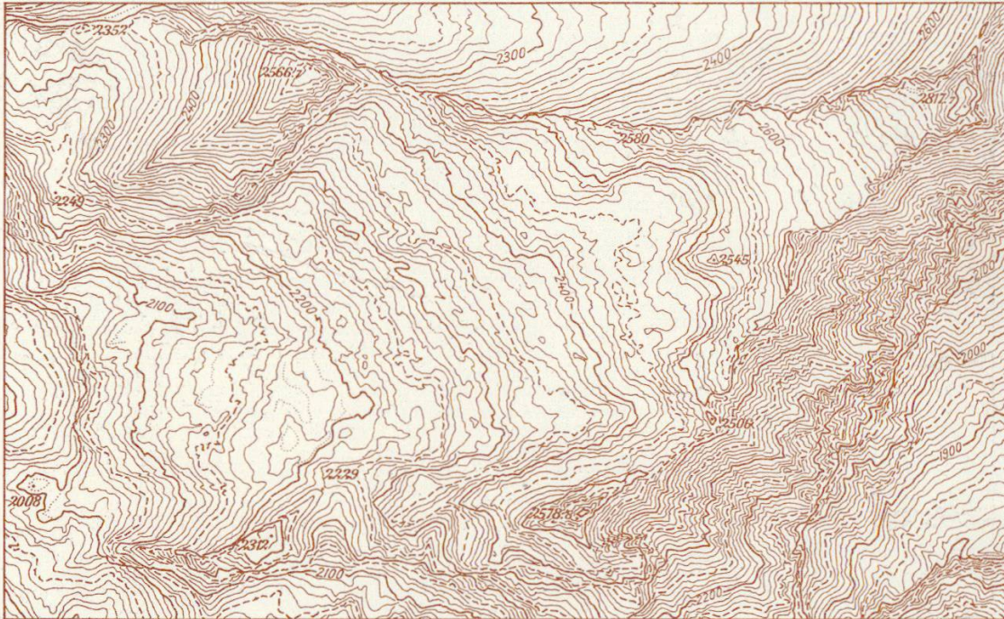
Abb. 23. Verlorrenberg; stereoautogrammetrisch gewonnenes Kurvenbild;
