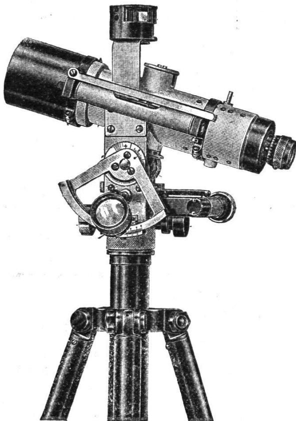
Zur optischen Messung rechtwinkliger Koordinaten in flachem und bergigem Gelände und zu Profilaufnahmen. Kippungsbereich des Fernrohres  $\pm 30^\circ$  Ablesung durch Nonius mit Lupe 1', Reduktionsteilung, Nivellier-Libelle. Genauigkeit der Distanzmessung 1 cm pro 50 m
