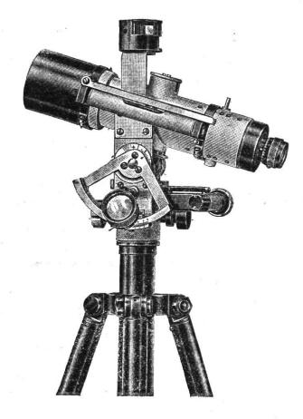
Zur optischen Messung rechtwinkliger Koordinaten in flachem und bergigem Gelände und zu Profilaufnahmen. Kippungsbereich des Fernrohres ±30° Ablesung durch Nonius mit Lupe 1', Reduktionsteilung, Nivellier-Libelle. Genauigkeit der Distanzmessung 1 cm pro 50 m
