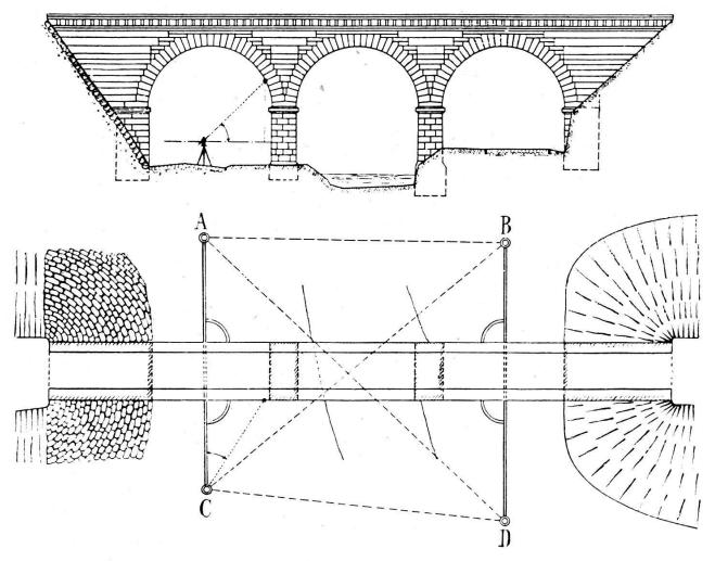
Auf 2 Geraden senkrecht zu den Stirnwänden werden beidseitig des Viaduktes im Terrain je 2 Fixpunkte errichtet, in Lage und Höhe genau auf die Stirnwände eingemessen und überdies untereinander in gegenseitige Beziehungen gebracht. Darauf wird ein Gehilfe mit einer langen, mit blankem Metallknopf versehenen Fischerrute auf eine hohe,
