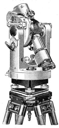
Optischer Präzisionsdistanzmesser für Polygonierung und Stückvermessung
