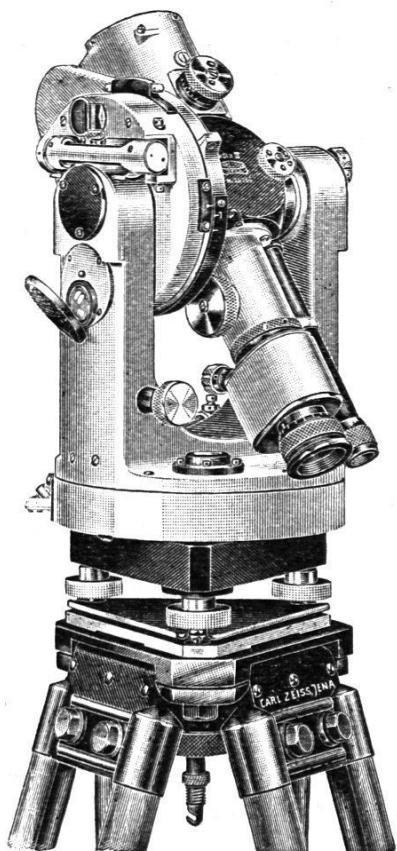
Optischer Präzisionsdistanzmesser für Polygonierung und Stückvermessung
