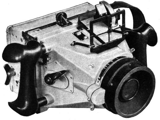
Fig. 1. — La chambre à main "Zeiss-Aerotopograph".
